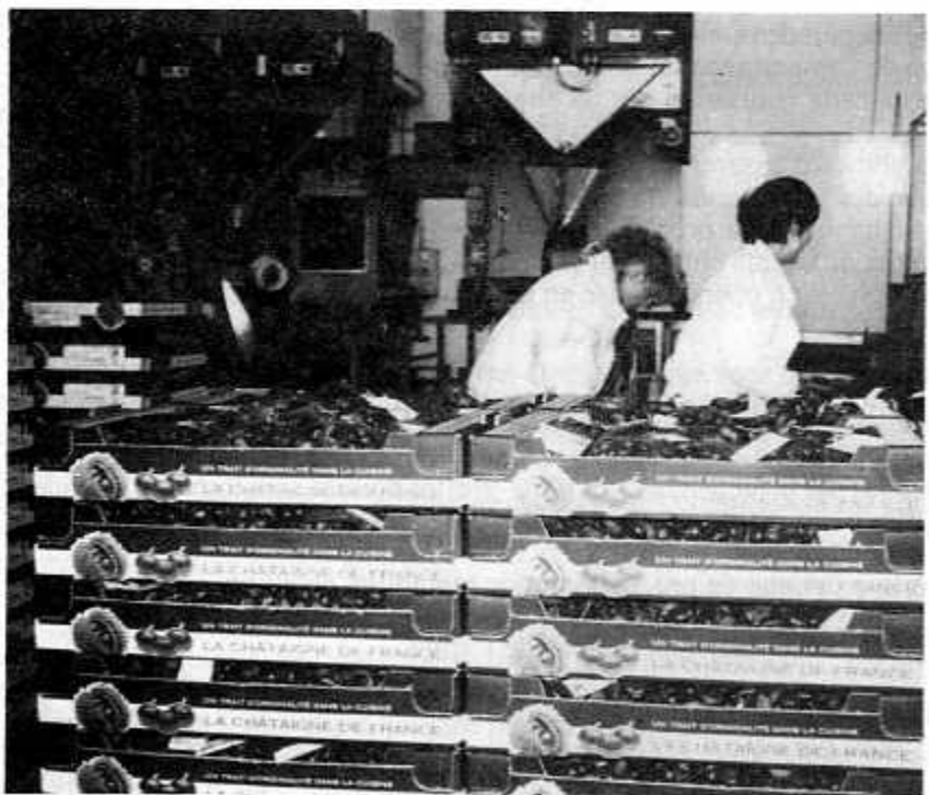
Conditionnement : les sacs de 1 kg sont rangés dans des plateaux avec des recettes à l'intérieur, 24 tonnes peuvent être ainsi conditionnées chaque jour
