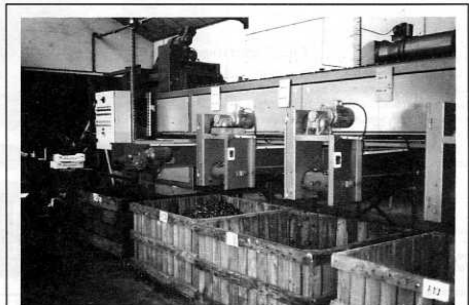
Calibrage : après avoir été époussiérées, trempées, essorées, les châtaignes sont calibrées, à raison de 30 tonnes par jour
